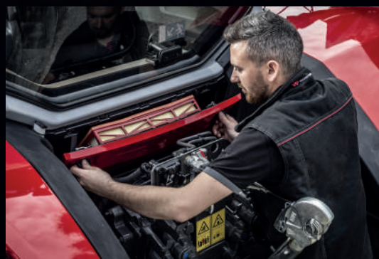
Zračni filter kabine jednostavan je za pristup i čišćenje.
