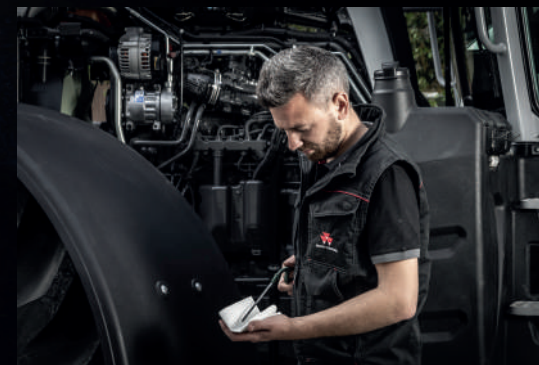
Prednja osovina i tanak suženi dizajn kabine omogućavaju jednostavan pristup šipci za ulje i filtru.
