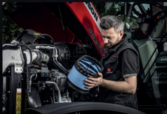
Filtru za zrak motora može se lako pristupiti i čistiti ga.
