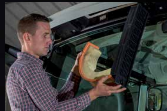
A fülkelégszűrő tisztítás céljából egyszerűen eltávolítható.
