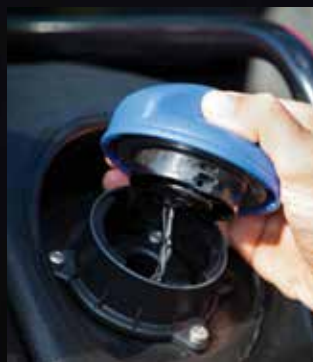
Az AdBlue®-tartály – átgondolt elhelyezésének következtében – védve van a magas és alacsony hőmérsékletektől. Mindkét tartály töltése biztonságosan és kényelmesen kivitelezhető.
