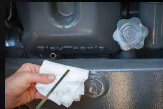
A karcsúsított kialakítású motortérburkolat és a mellső híd kialakítása kényelmes hozzáférést biztosít a motorolaj-szűrőkhöz és az olajsínt-ellenőrző pálcához.
