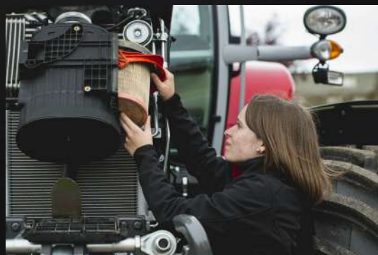
A motor légszűrője könnyen hozzáférhető és tisztítható.
