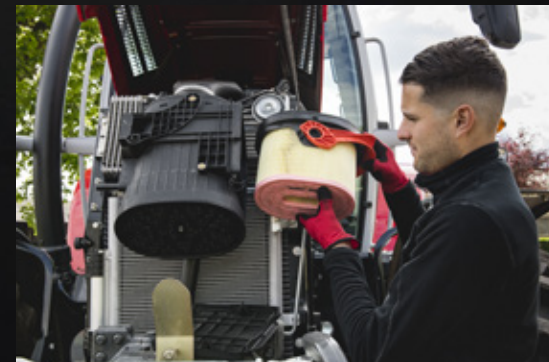
A motor légszűrője könnyen hozzáférhető és tisztítható.
