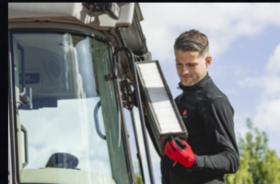
A fülke légszűrője könnyen hozzáférhető a tisztítás céljából történő kisereléshez.
