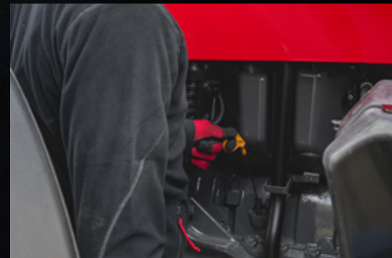
A mellső híd és a „karcsúsított” motorháztető kialakításának köszönhetően az olajszint-ellenőrző nívópálca és a szűrő is könnyen hozzáférhető.
