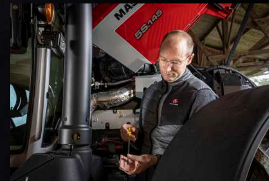
A mellső híd és a „karcsúsított” motorháztető kialakításának köszönhetően a motorolaj nivópálcaja és szűrője könnyen hozzáférhető.
