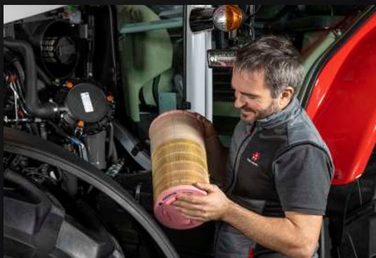
A motor légszűrője könnyen hozzáférhető és tisztítható.
