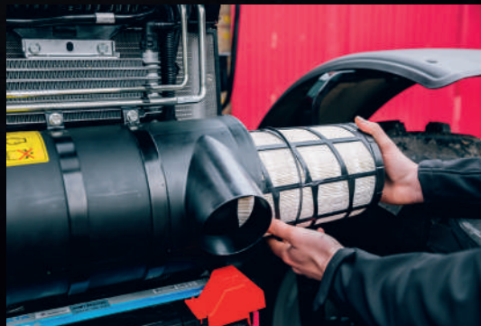
A motor légszűrője könnyen hozzáférhető és tisztítható.
