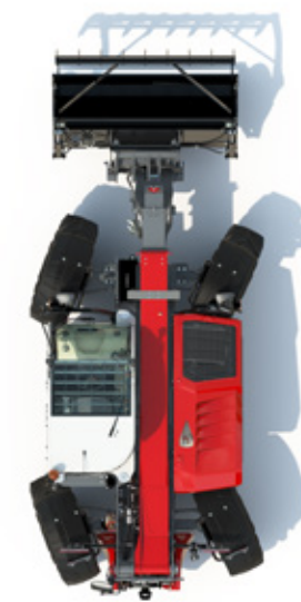
NÉGYKERÉK-kormányzási mód – a minimális fordulási sugár érdekében.
