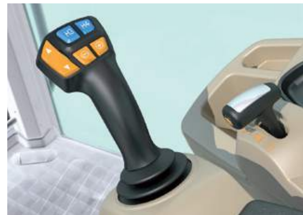
Az MF 5700 S Essential fülkeopció a rakodó elektronikus többfunkciós botkormányával
