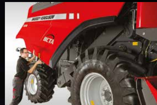
Megvilágítással rendelkező, egy darabból álló panelek teszik lehetővé a gyors ellenőrzési célú hozzáférést
