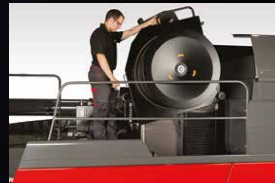
A hűtőradiátor a tisztítás érdekében könnyen hozzáférhető
