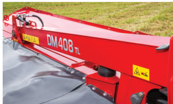
Központi tartó hidraulikus billenéscsillapítással
