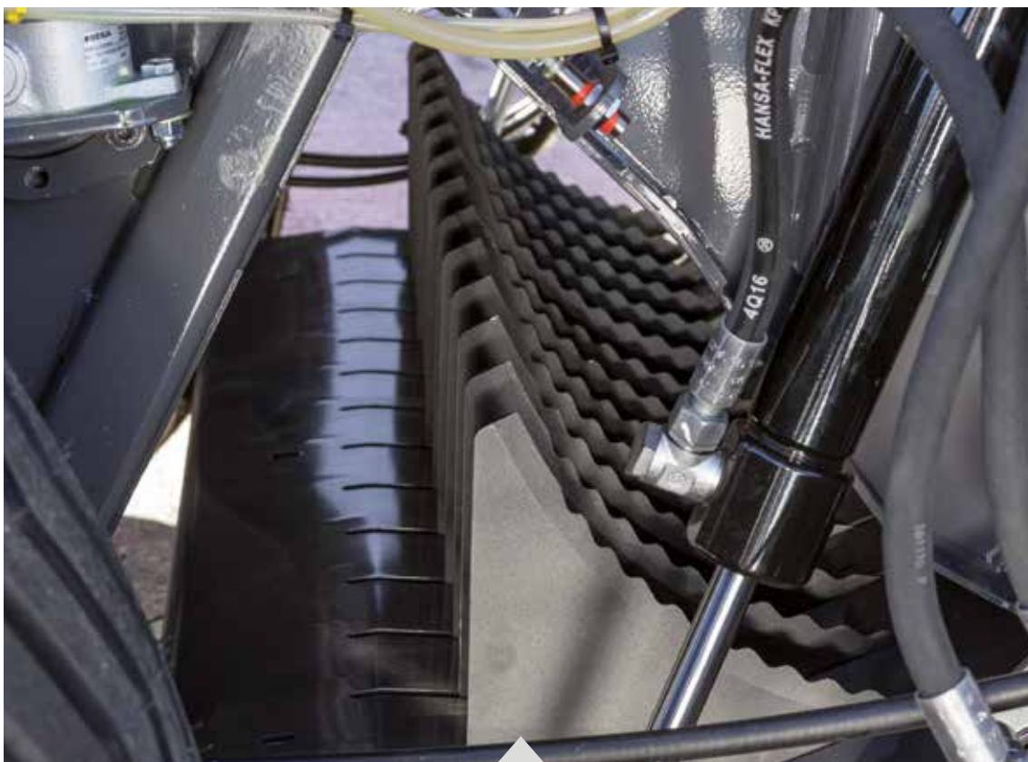
Xtracut 13 rotor 90 mm-es elméleti szecskahosszal
