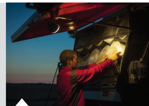
A zsinegtároló szekrények megvilágítása megkönnyíti az éjszakai feltöltést.
