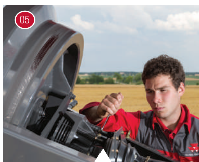
A lendítőkerék csúszókuplungjának beállítása.
