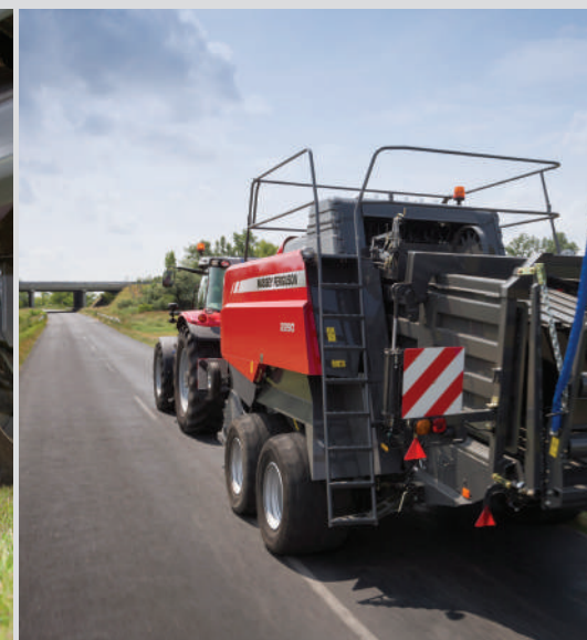
A tandem tengely nagy közúti sebességet tesz lehetővé, és a táblák közötti átállásnál kiváló menettulajdonságokat biztosít.
