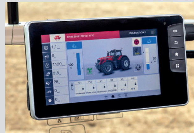
A bálázó vezérlése a traktor ISOBUS termináljáról
