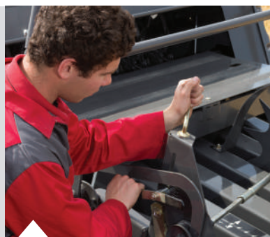
Egyértelmű és megbízható bálahossz-állítás. A bálakamra középvezetékében felszerelve található egy bálahossz-érzékelő csillagkerék, amely a felső bálahatároló fallal együtt mozog, így biztosítva, hogy a csillagkerék minden terményállapot mellett szorosan kövesse a bálát, és a bálahossz mérése pontos legyen.
