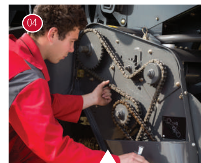
A rendfelszedőlánc feszességének ellenőrzése.
