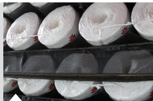
A zsinegtekercek behelyezése egyszerű, és a tekercek még a hegyoldalon dolgozva sem mozdulnak el.
