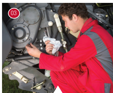
Az aprítórotor-hajtómű olajszintjének ellenőrzése.
