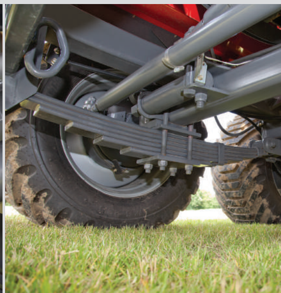
Független, laprugós felfüggesztés minden keréknél.
