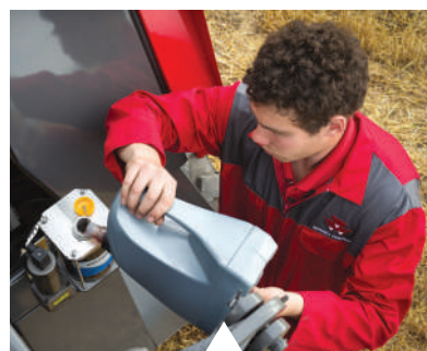
Az automata láncolajozó utántöltése.
